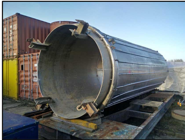
Abbildung 2: Antimagnetisches Verbaurohr
